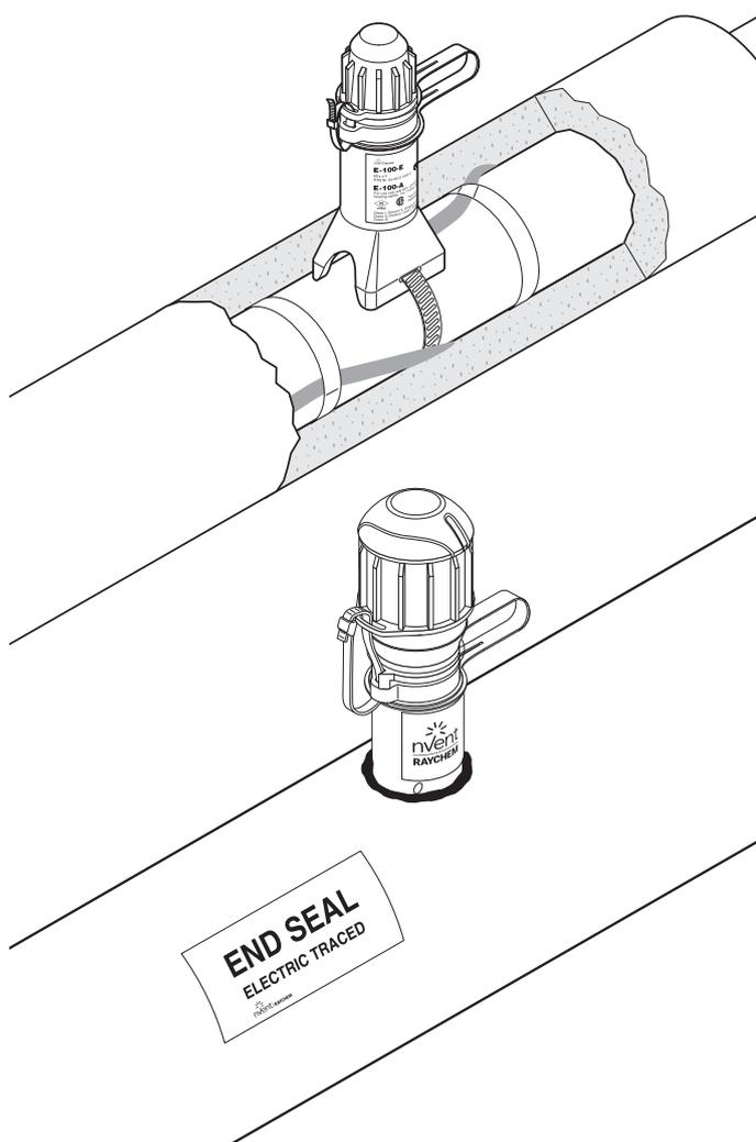
Les modèles nVent RAYCHEM E-100-E et E-100-L-E sont des modules de terminaison accessibles et ouvrables, le second étant équipé d'un témoin lumineux. Ils s'adaptent sur tous les rubans chauffants industriels parallèles de nVent RAYCHEM BTV, QTVR, XTVR, HTV ou VPL et sont agréés pour un usage en zones explosibles. Leur boîtier robuste et moulé d'une épaisseur de 4 mm les rend extrêmement résistants.
