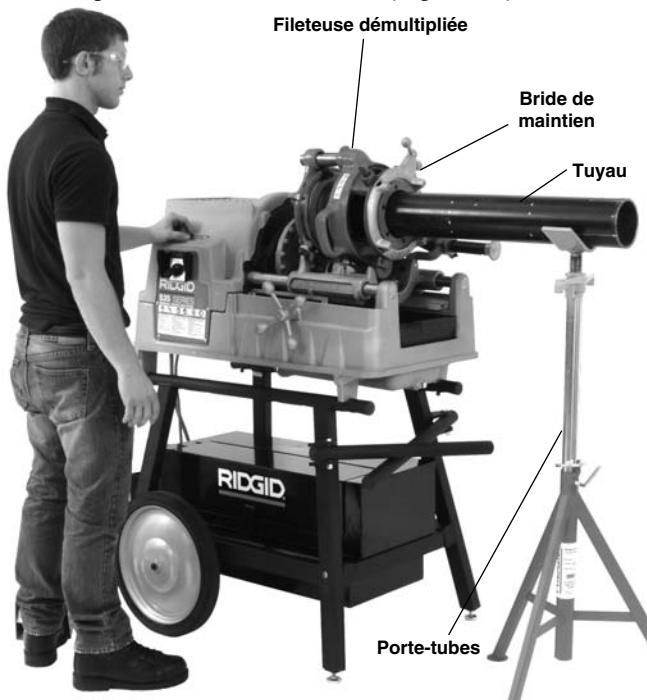
Figure 21 – Position de travail en montage direct
