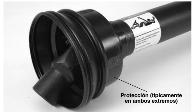
Figura 9 – Protección en el eje de transmisión 840A y advertencia
