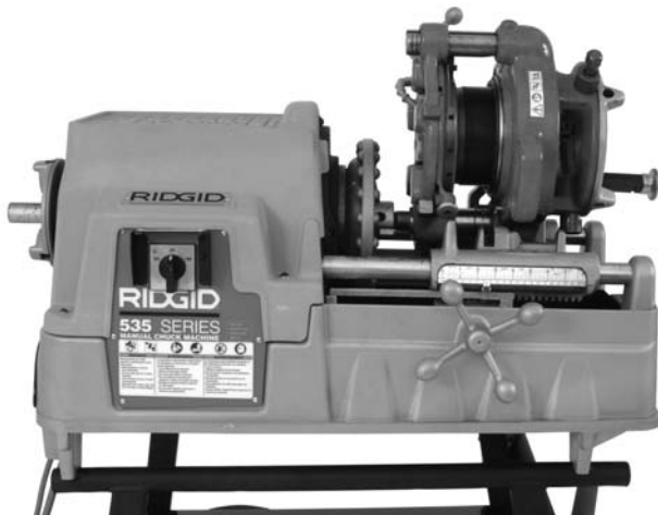
Figura 17 – Roscadora a engranajes acoplada directamente a la máquina 535
