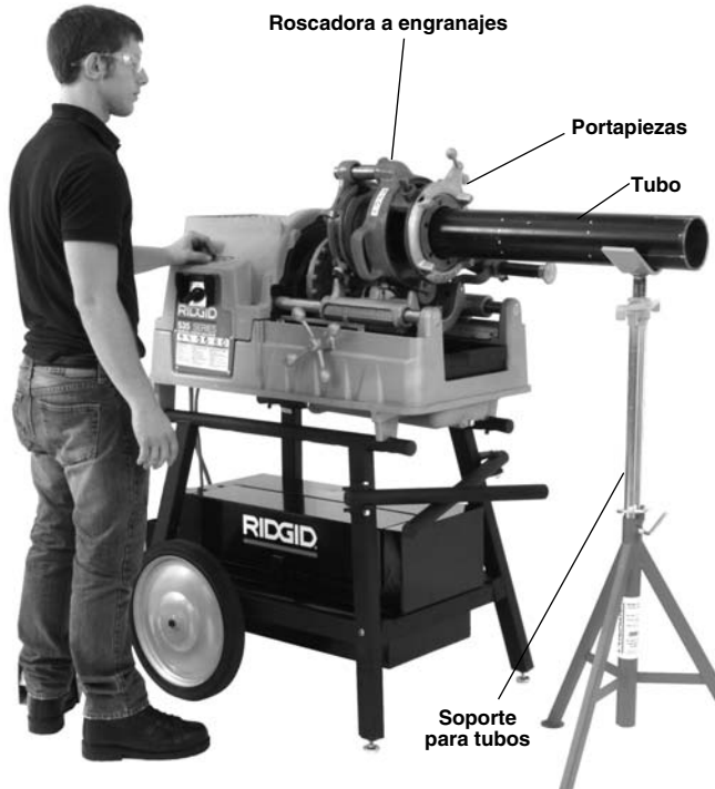
Figura 21 – Posición de operación (método de acoplamiento directo)
