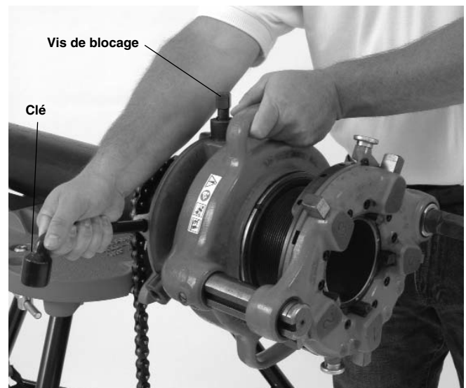
Figure 6 – Serrage de la bride de maintien
