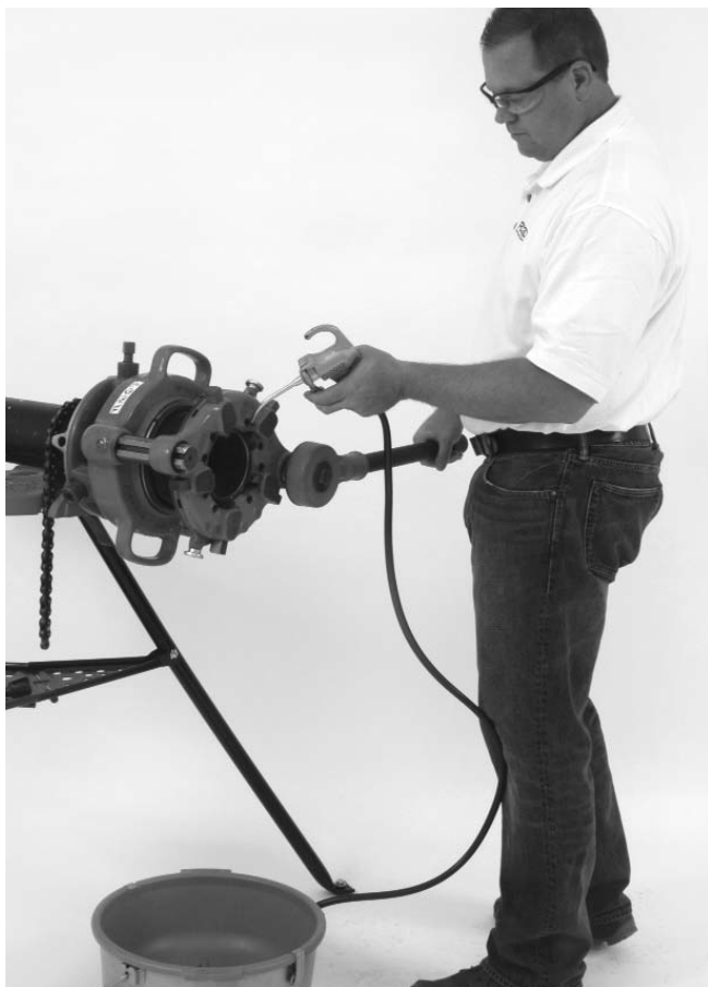
Figure 7 – Utilisation de la clé à cliquet D-1440
