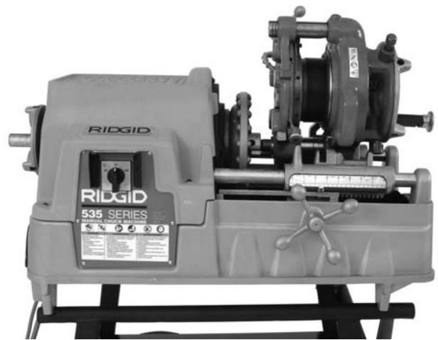
Figure 17 – Fileteuse démultipliée en montage direct avec 535
