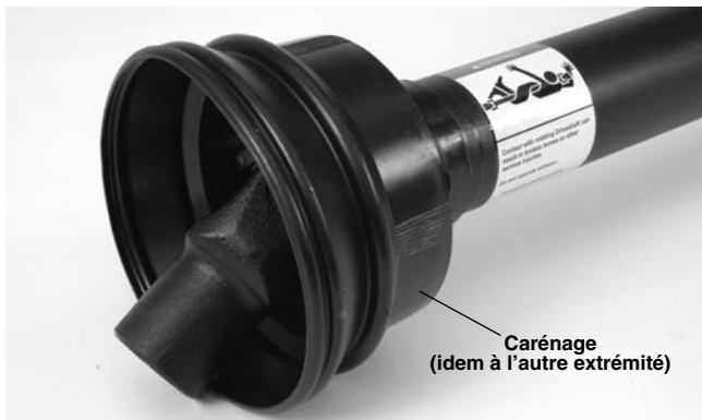
Figure 9 – Carénage et fiche signalétique de l'arbre de transmission 840A
