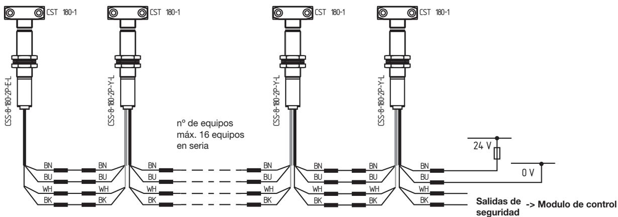
El primer sensor final/ de terminación CSS-8-180-...E-L no tiene entradas de seguridad.
