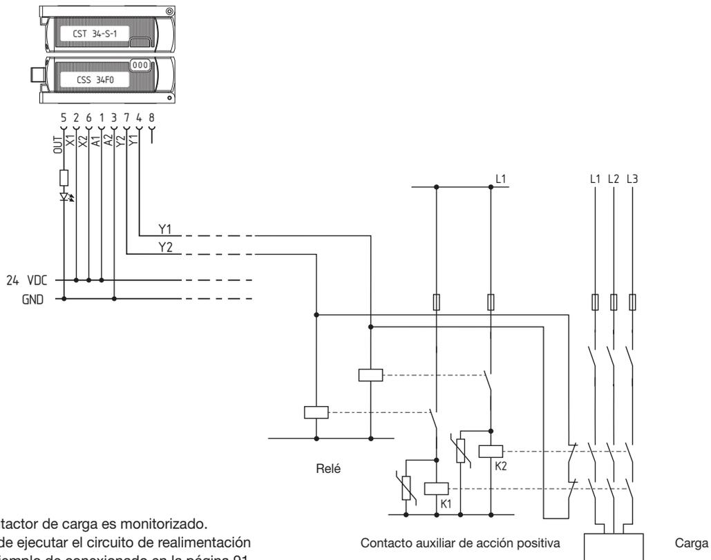
El contacto NC del contactor de carga es monitorizado.
