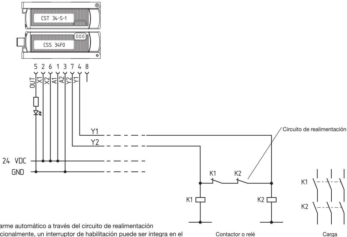
Rearme automático a través del circuito de realimentación
