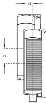
El accionamiento lateral permite una máxima altura de desalineación ( $V_1$ ) entre el sensor y el actuador de 36 mm (Ej. Para absorber tolerancia de montaje o vibración del resguardo) Se pueden conseguir incrementos en la desalineación de hasta máx. 53 mm, utilizando el actuador CST 34-S-2. La desalineación axial ( $V_2$ ) es de máx.  $\pm 10$  mm
