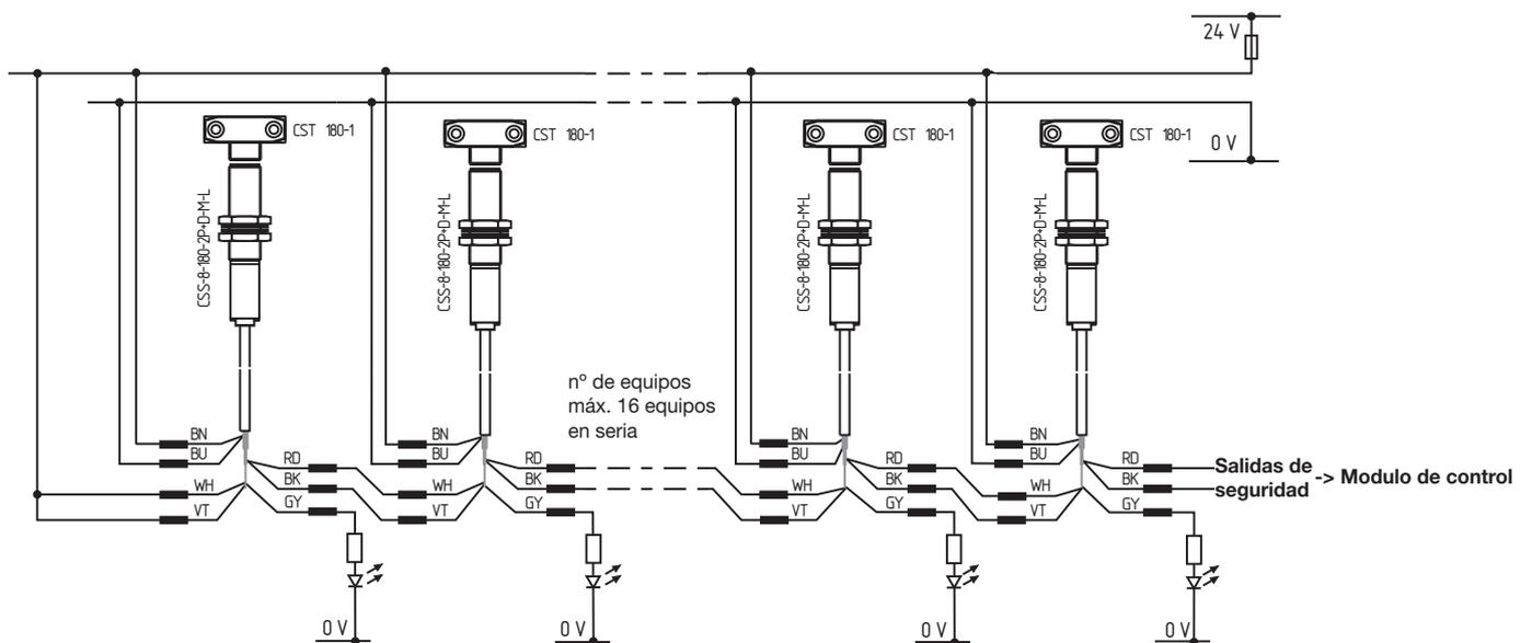
Las entradas de seguridad del último sensor (Tipo "M") que empieza desde el relé de seguridad son también utilizadas para el conexionado en serie. La tensión de los canales de seguridad es suministrada desde aquí.
