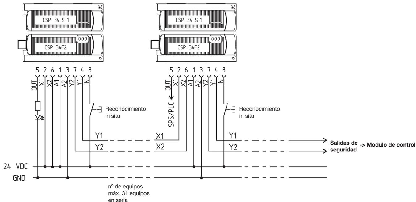
El sensor de seguridad CSP 34F2 puede ser utilizado en cualquier posición de la configuración serie. Para habilitar las salidas, el pulsador de rearme con detección de flanco debe ser reconocido in situ cuando el sensor de seguridad es actuado. El reconocimiento permite un control en la zona peligrosa previo al arranque de la instalación.
