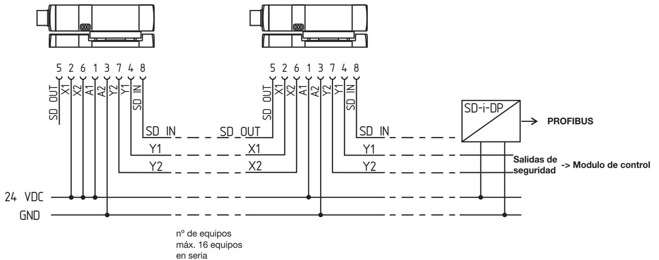
Las salidas de seguridad del primer dispositivo de bloqueo magnético son conectadas al relé de seguridad. El Gateway PROFIBUS es conectado a la entrada de diagnosis serie del primer dispositivo de bloqueo magnético.
