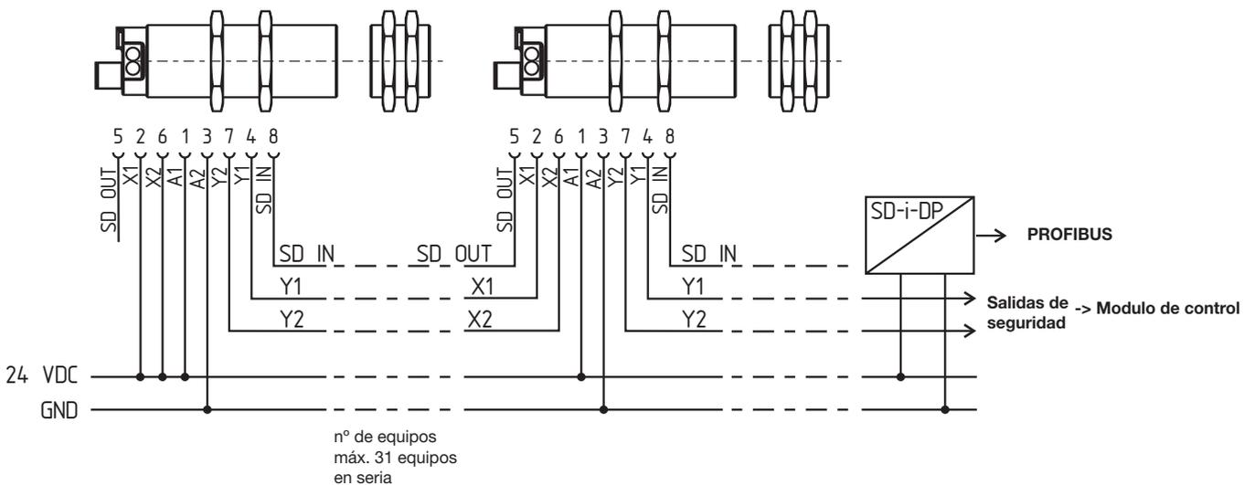
Las salidas de seguridad del primer sensor son conectadas al relé de seguridad. El Diagnóstico serie del Gateway es conectada a la entrada de diagnóstico serie del primer sensor.
