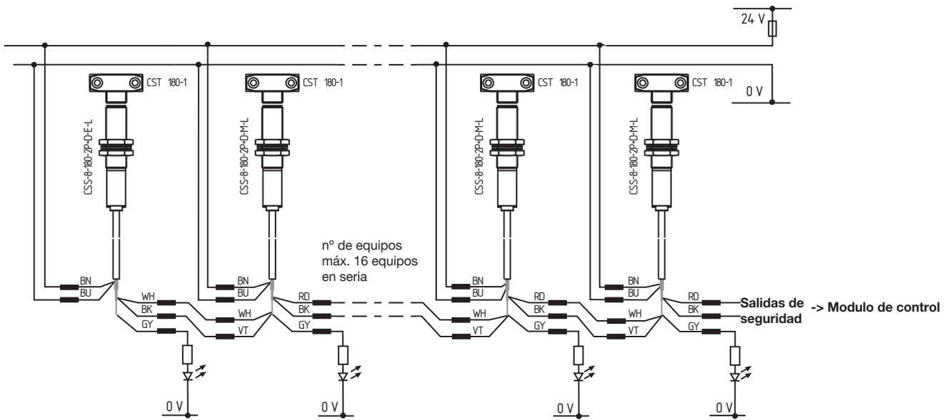
El sensor final CSS-1-180-...-E-L no tiene entradas de seguridad. El CSS-7-180LC-2P-E-L opcionalmente puede ser utilizado como sensor final. Este no posee entradas de seguridad o salida de diagnóstico.
