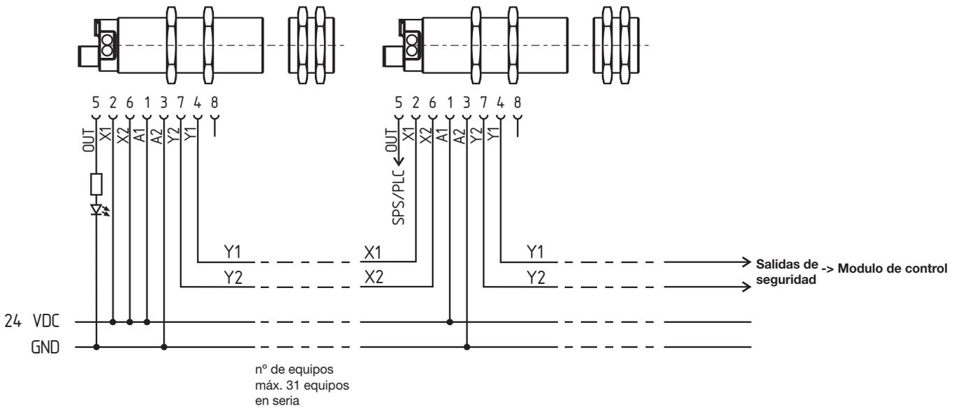
Se aplica tensión en ambas entradas de seguridad del último sensor de la cadena (visto desde el modulo de seguridad).
