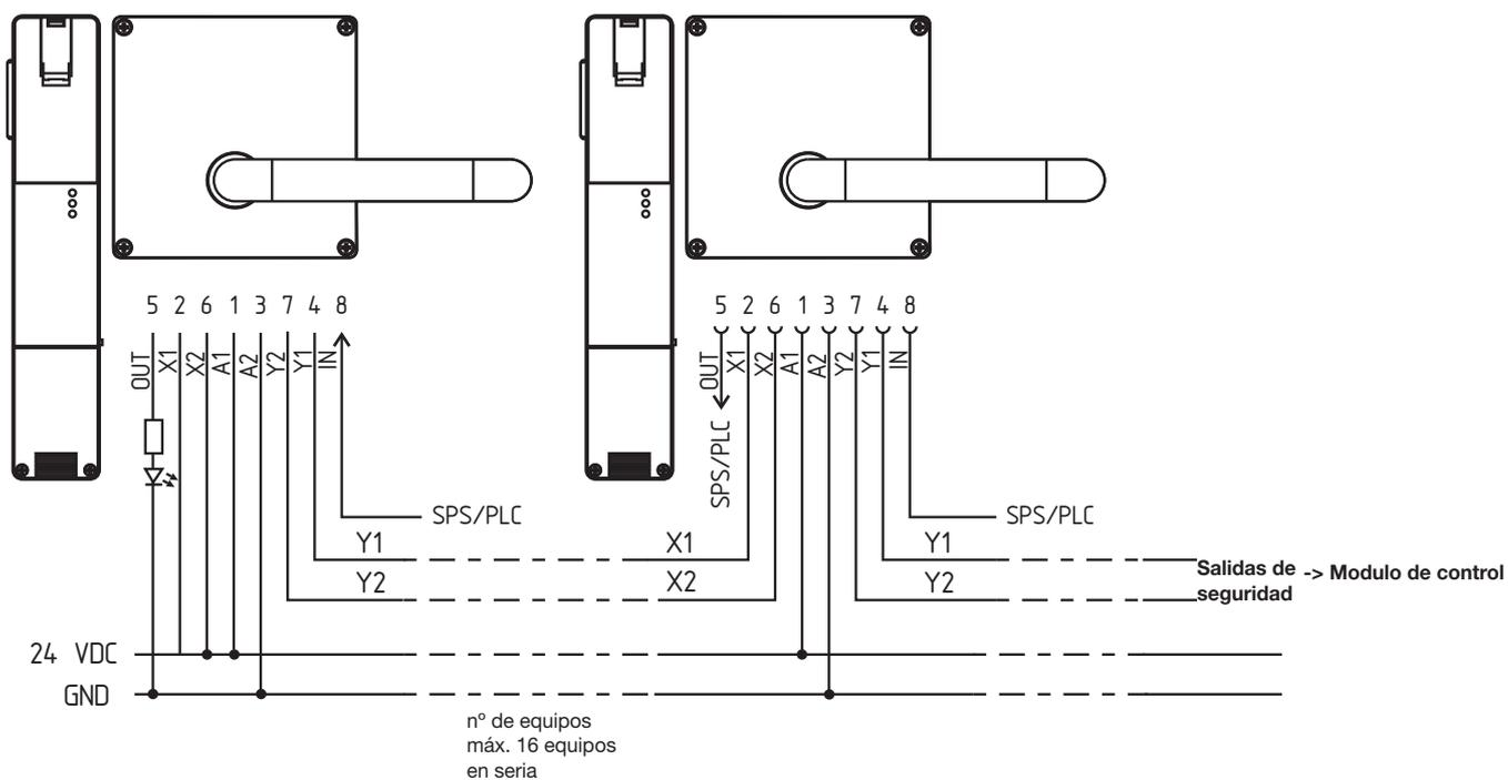
En este ejemplo bloqueo por resorte, la bobina se debe energizar para abrir la protección. En el caso de bloqueo por tensión, la bobina debe estar energizada para mantener la protección bloqueada.
