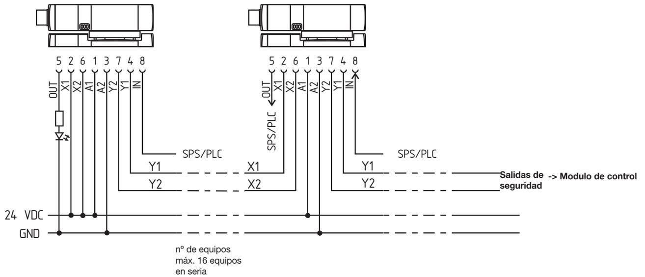
Se aplica tensión en ambas entradas de seguridad del último sensor de la cadena (visto desde el módulo de seguridad). Las salidas de seguridad del primer sensor se conectan al módulo de seguridad.
