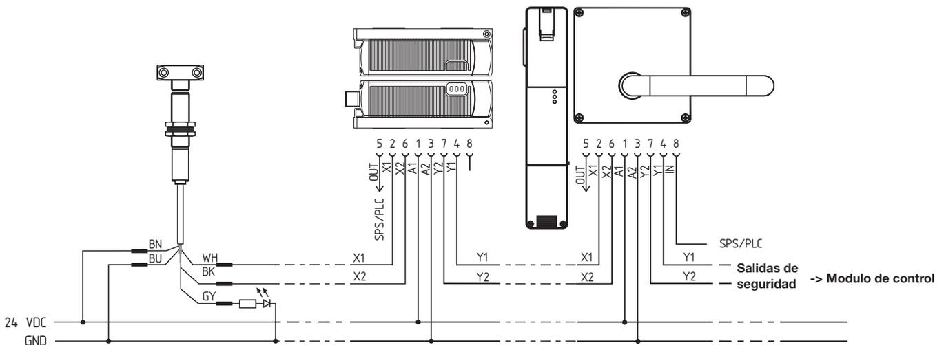
Los equipos CSS 180, CSS 34, MZM 100, AZ 200 y AZM 200 pueden ser conectados en serie y en cualquier orden. El CSS 180 permite hasta 16 equipos, el CSS 34 y el AZM 200 permite hasta 31 equipos. En el caso de mezclar CSS 180 con otros dispositivos se reduce la serie hasta un máximo de 16 equipos.
