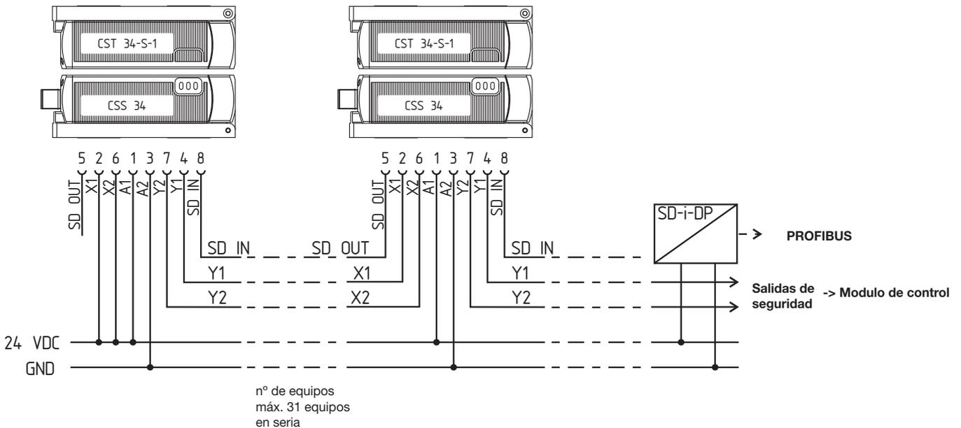
Las salidas de seguridad del primer sensor son conectadas al relé de seguridad. El Diagnóstico serie del Gateway es conectada a la entrada de diagnóstico serie del primer sensor.
