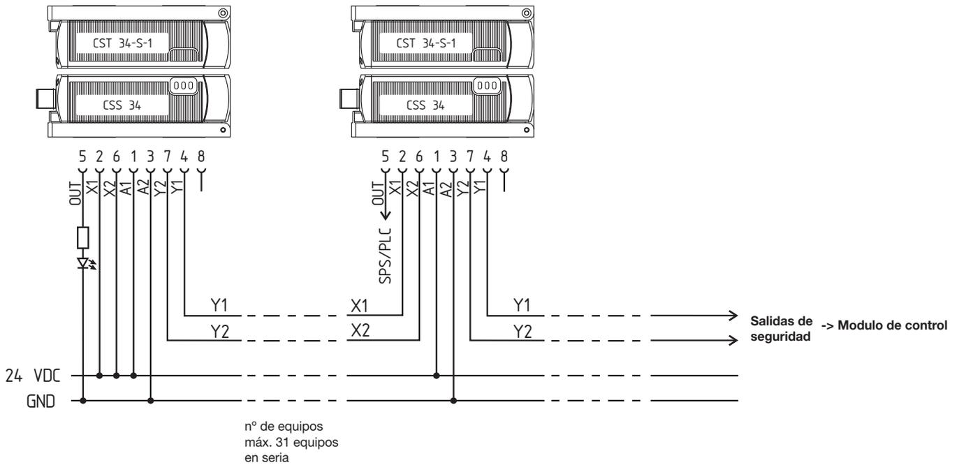
Se aplica tensión en ambas entradas de seguridad del último sensor de la cadena (visto desde el módulo de seguridad). Las salidas de seguridad del primer sensor se conectan al módulo de seguridad.
