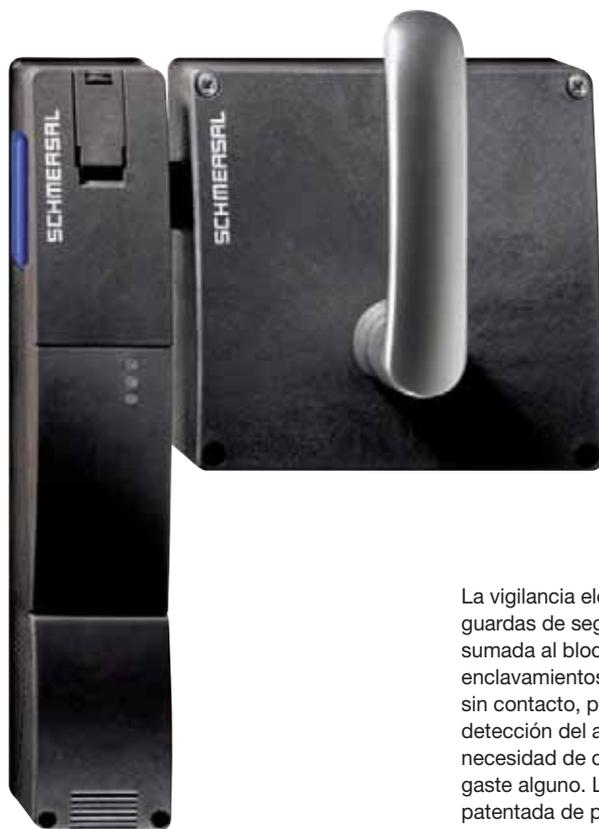
La vigilancia electrónica de guardas de seguridad móviles sumada al bloqueo mediante enclavamientos por solenoide sin contacto, permiten una detección del actuador sin necesidad de contacto ni desgaste alguno. La tecnología patentada de pulso-eco permite amplias tolerancias en la aproximación del actuador codificado, tanto en la distancia de conmutación como en la desalineación. A pesar de ello, los puntos de conmutación e histéresis son extremadamente reiterativos y constantes.
