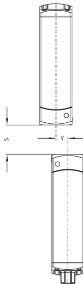
El accionamiento frontal permite un máximo de desalineación transversal ( $V$ ) de aproximadamente 8 mm.
