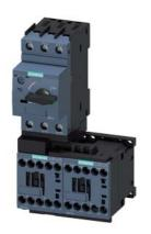
FUSELESS MOTOR STARTER REVERSING OPERATION 600V AC SZ S00 0.18-0.25A 220/240V AC 50/60HZ SCREW CONNECTION FOR SCREW MOUNTING OR 35 MM RAIL-MOUNTING TYPE OF COORDINATION 2 IQ = 150 KA ALSO FULFILLS TYPE OF COORDINATION 1 1NC (PER CONTACTOR)
