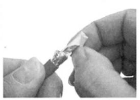
8. Falls beim Abisolervorgang die weiße Füllmasse nicht mit entfernt wurde, diese durch Abziehen von Hand entfernen.
