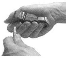
7. Leitungsreste verbleiben im Werkzeug. Nach dem Entspannen des Werkzeugs können die Leitungsreste entnommen werden.
