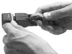
3. Einlegen des abgemessenen Leitungsendes in das Abisolierwerkzeug. Anschlag für die Einlegetiefe ist der Zeigefinger der linken Hand.
