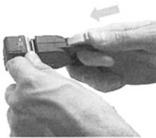
4. Leitung im Abisolierwerkzeug bis zum Anschlag festspannen.
