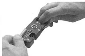
2. Abmessen der Leitungslänge durch Anlegen der Leitung an der Maßschablone. Anschlag mit dem Zeigefinger der linken Hand.
