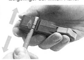
6. Abisolierwerkzeug im geschlossenen Zustand vom Leitungsende abziehen. Bei schlechtem Schnittergebnis Messerkassette wechseln.
