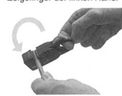
5. Abisolierwerkzeug zum abisolieren der Leitung bei PVC-Isolierung ca. 4 mal, bei PUR- oder PE-Isolierung ca. 8 mal in Pfeilrichtung drehen.
