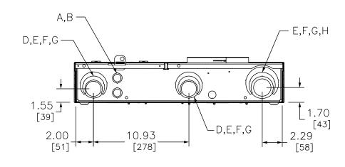
FINISH — GRAY BAKED ENAMEL POWDER COAT PAINT OVER CLEANED GALVANNEALED STEEL. UL LISTED — FILE E—6294, VOL M.
