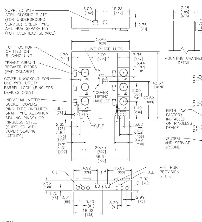
FINISH — UL COMPONENT RECOGNIZED GRAY BAKED POWDER COAT PAINT OVER CLEANED PHOSPHATIZED STEEL. UL LISTED — FILE E-6294. SUITABLE ONLY FOR USE AS SERVICE EQUIPMENT. SUITABLE FOR OH/UG SERVICE.
