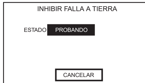
Figura 46 – Pantalla de activación “Inhibir falla a tierra”
