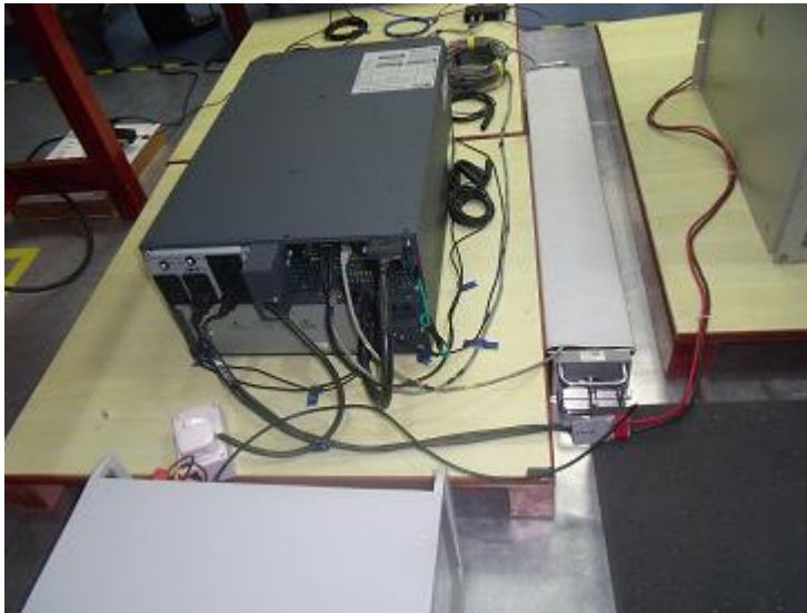
EFT on Ethernet on NMC
