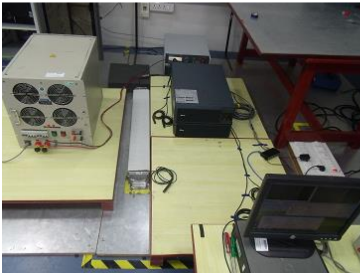
EFT on Universal I/O 1 on NMC
