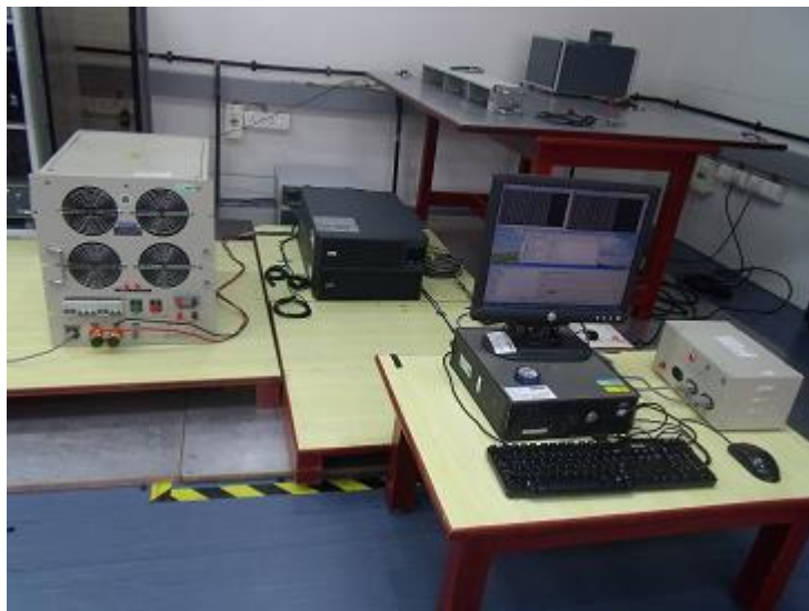
EFT on AC output power lines
