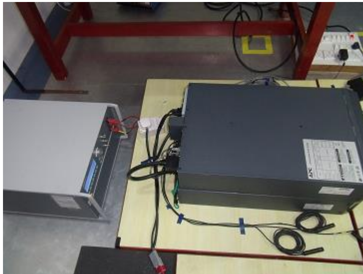
EFT on AC input power lines
