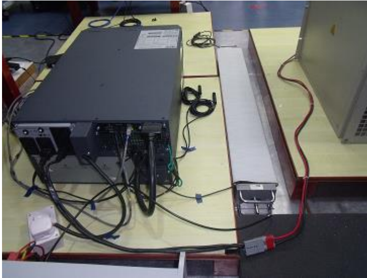
EFT on Universal I/O 2 on NMC
