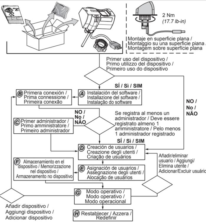
**Harmony XB5SSoft:** es obligatorio instalar este software para poder utilizar el dispositivo XB5S. Para descargarlo, vaya a [www.schneider-electric.com](http://www.schneider-electric.com)
