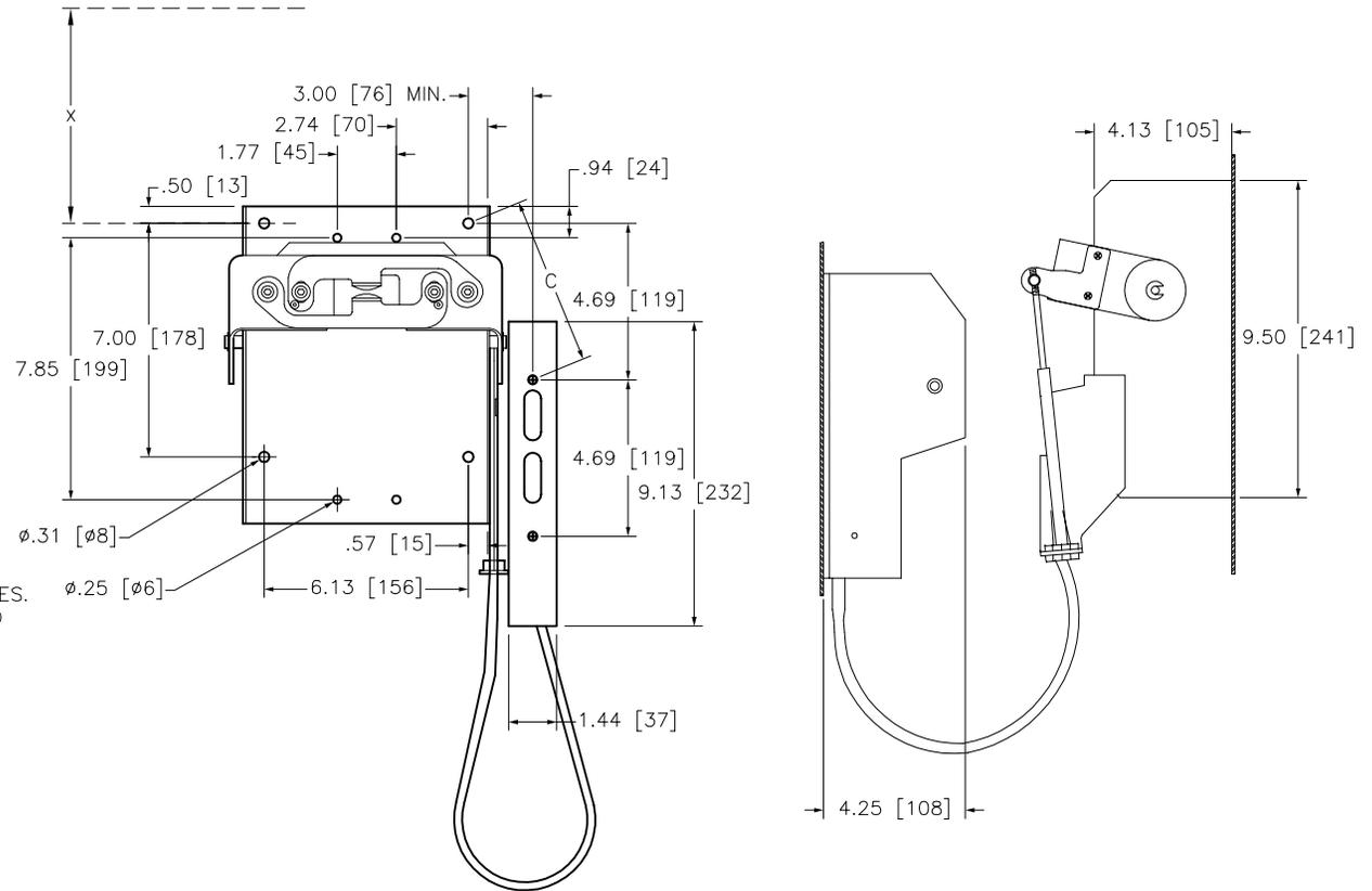
NOTE: BEND RADIUS IN CABLE MUST NEVER BE LESS THAN 6 INCHES. ELECTRICAL CLEARANCES MUST BE MAINTAINED BETWEEN CABLE AND LIVE ELECTRICAL PARTS.
