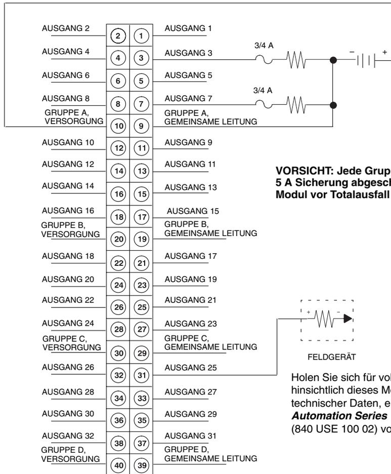
**VORSICHT: Jede Gruppe wird mit einer 5 A Sicherung abgesichert, um das Modul vor Totalausfall zu schützen.**
