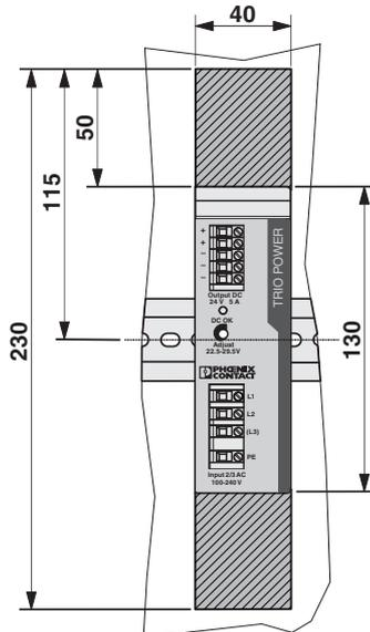
Posición de montaje: Profundidad de montaje 115 mm (+ carril)
