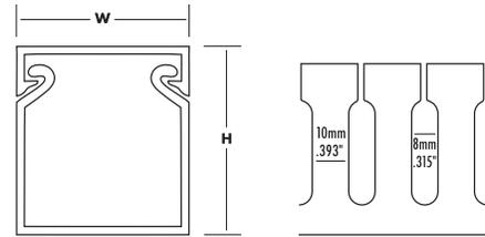
Finger width = 10 mm, slot width = 8 mm.
