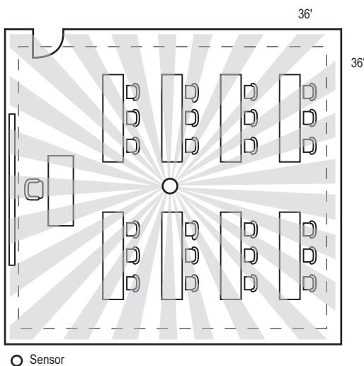
Si el espacio es superior a 30' x 30', se deberá utilizar más de un sensor para asegurar una cobertura completa.
