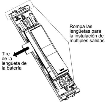
Si lo instala con una placa de pared no radiant, omita los pasos 4a y 4b anteriores y use los tornillos que se incluyen con la otra placa de pared para asegurar este dispositivo.
