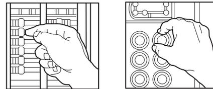
Luego, conecte la lámpara o radio en el otro tomacorriente del receptáculo y enciéndala para verificar que no haya tensión en ninguno de los dos tomacorrientes. Si hay tensión, detenga el trabajo y llame a un electricista para que complete la instalación.
