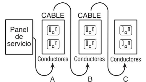
Colocar el AFCI/interruptor diferencial en la posición A también protegerá a los receptáculos B y C "del lado de la carga". En cambio, colocar el interruptor diferencial en la posición C no brindará protección a los receptáculos A ni B. Recuerde que los receptáculos A, B y C pueden estar en habitaciones distintas.
