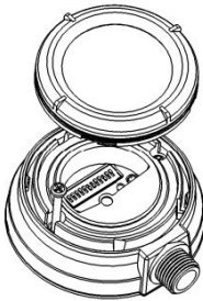
Fig. 1 - instalación de la lente
