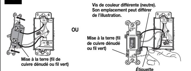
**UNIPOLAIRE :** Les fils recouverts sont raccordés à deux vis de la même couleur. Remplacer par un gradateur UNIPOLAIRE. Voir l'étape 5a.
