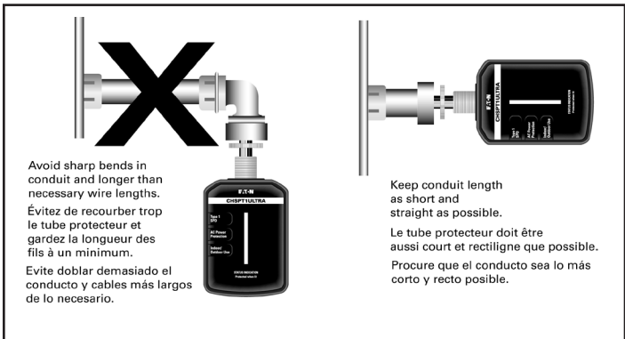
Figure 3. Conduit Installation / Installation à travers un tube protecteur / Instalación del conducto
