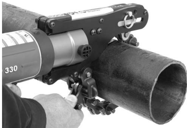
Figure 4 – Ramener la chaîne autour du tuyau
