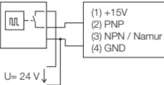
Commutateur capacitif 3 fils à sortie NPN
