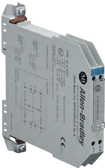
La barrera Zener impide la transferencia de energía excesiva de la zona segura a la zona peligrosa. Los diodos Zener en la barrera Zener están conectados en sentido inverso. No se supera el voltaje de ruptura de los diodos en funcionamiento normal. Si se supera este voltaje debido a un fallo en la zona segura, los diodos comienzan a conducir, lo que hace que se funda el fusible. La barrera Zener tiene polaridad positiva; es decir, que los ánodos de los diodos Zener tienen conexión a tierra.
