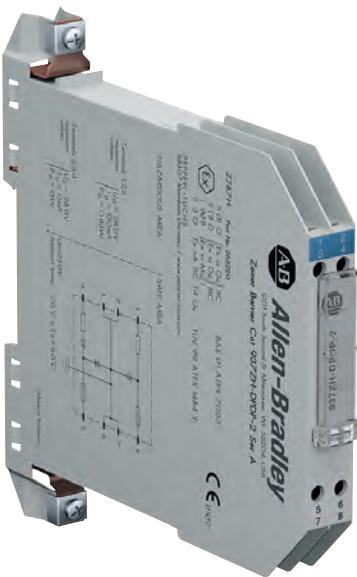
La barrera Zener impide la transferencia de energía excesiva de la zona segura a la zona peligrosa. Los diodos Zener en la barrera Zener están conectados en sentido inverso. No se supera el voltaje de ruptura de los diodos en funcionamiento normal. Si se supera este voltaje debido a un fallo en la zona segura, los diodos comienzan a conducir, lo que hace que se funda el fusible. La barrera Zener tiene polaridad positiva; es decir, que los ánodos de los diodos Zener tienen conexión a tierra.
