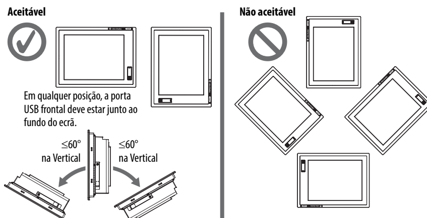
Figura 14 - Posições de Montagem Aceitáveis e Não Aceitáveis para Computadores Com Monitor
